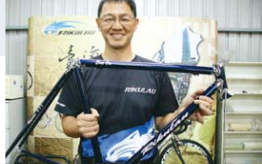
Chengnon Hsu mit einer Rikulau Einzelanfertigung: gelöteter Edelstahlrahmen mit Reynolds-953-Rohren und edlen Ziermuffen.
