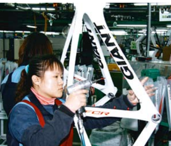
Giant-Karbonrahmen made in Taiwan werden per Hand Stück für Stück aufgebaut.
